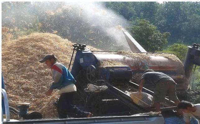
รูปที่ 8.4 การกะเทาะเมล็ดข้าวโพดด้วยเครื่องกะเทาะ
