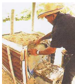
รูปที่ 5.62 การจัดเตรียมเตาเผาผลิตถ่าน 200 ลิตร แบบนอน
